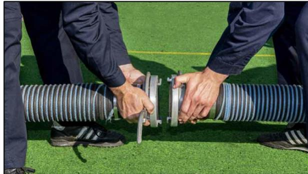
Es ist jedoch auch bestimmungskonform, wenn der Kupplungsschlüssel nur mit beiden „Nasen“ den Metallteil der unteren Fläche der Kupplung berührt (untere Fläche der Kupplung: siehe Abb. 30.)
